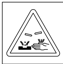
RIESGO DE CORROSION SUSTANCIAS CORROSIVAS
