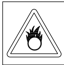
¡PELIGRO! MATERIAL COMBURENTE
